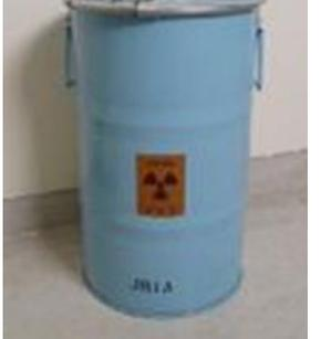
50L ドラム缶の天蓋を閉めて、放射性廃棄物シールを 50L ドラム缶の側面に 1 枚貼付します。
