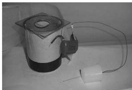
図5 コンデンサの取り付け
