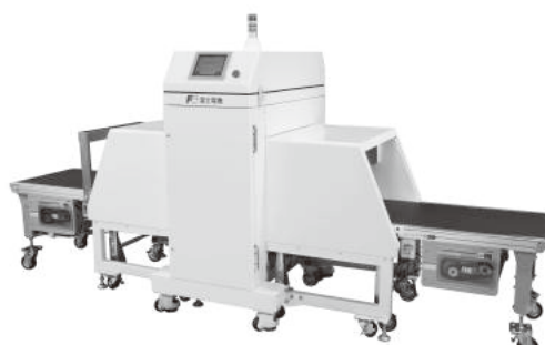
米袋単位で測定する米モニタ
