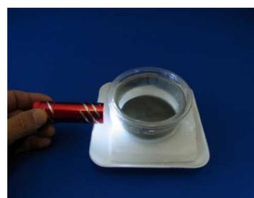
(3) 放射線の観察 2 (セラミックボールから出る放射線)：観察容器 (①) の底面に、ラジウムセラミックボール (⑤) を置き、観察 1 と同様に、セラミックボールから出る放射線を観察する。
