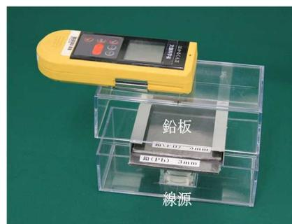
測定中の様子 (鉛板厚さ6mm (3mm×2枚) の状態)
