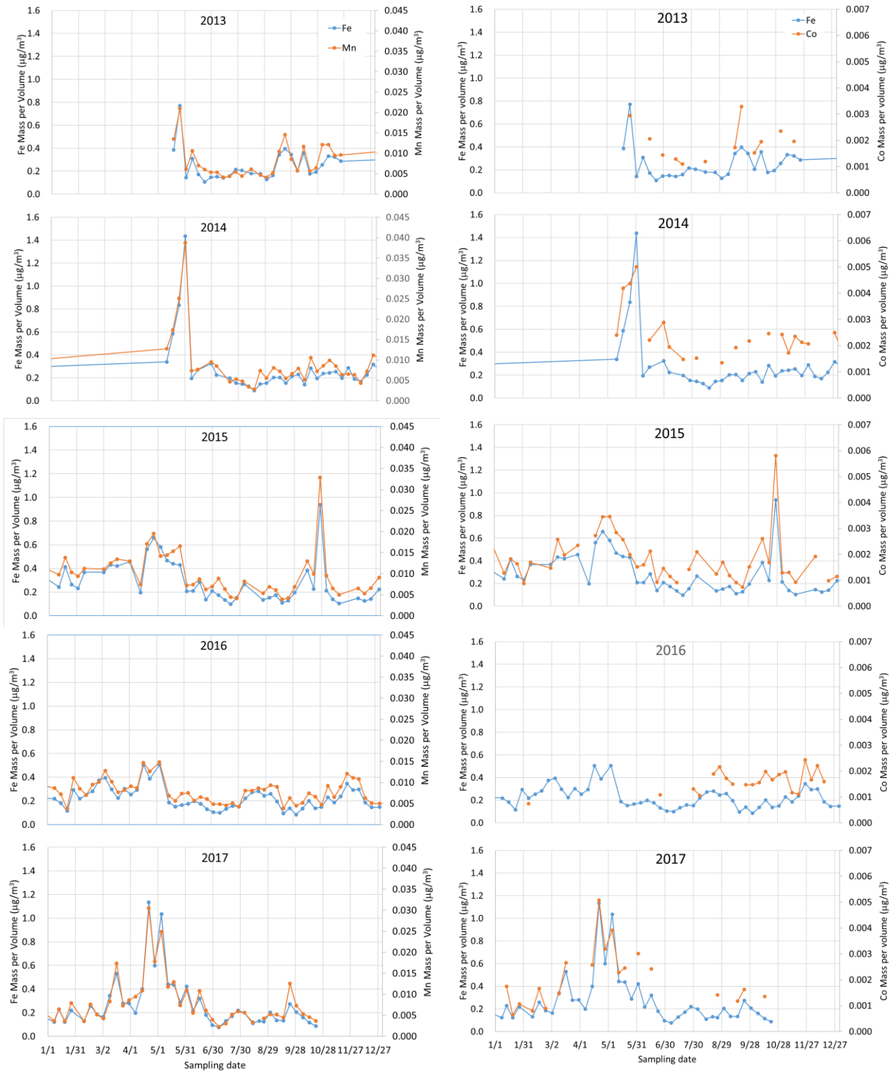
図6. エアロゾル中のMnとCoの濃度の変化をFeと比較。横軸は試料の採取日、縦軸は吸引した空気量あたりの濃度。
