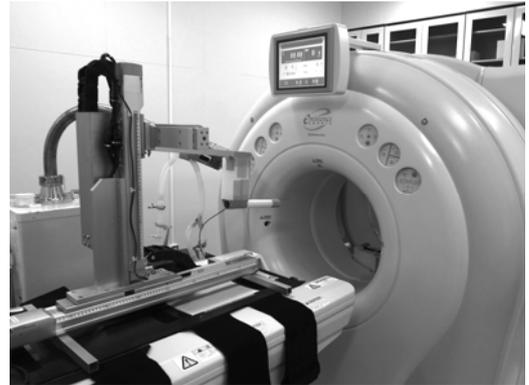
図 1 SET 3000GC/M と 3 軸直交ロボ
