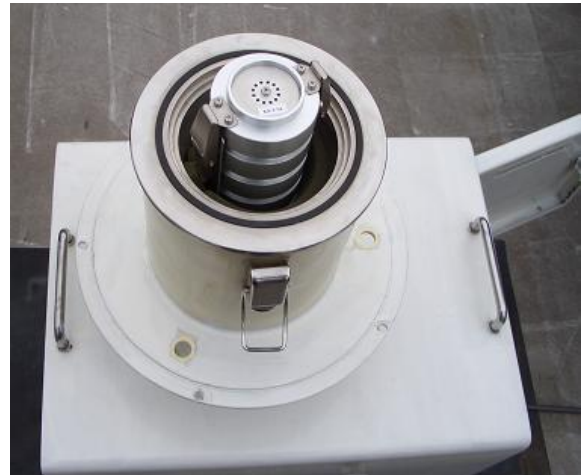
図 1 ローボリュームエアサンプラー内に設置した 3 段 NLAS インパクター
