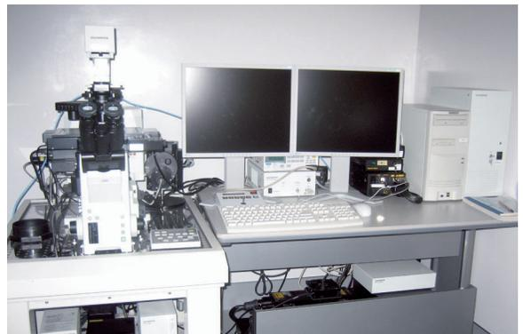
図6 共焦点レーザー走査顕微鏡
