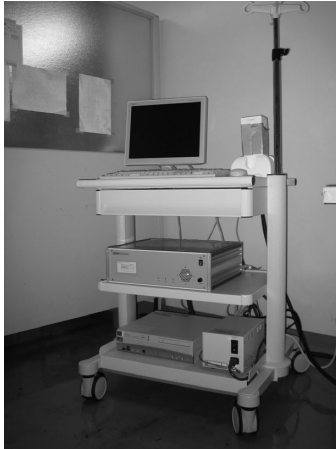
図1 CdTe 半導体検出器搭載小型ガンマカメラシステムの基本構成
