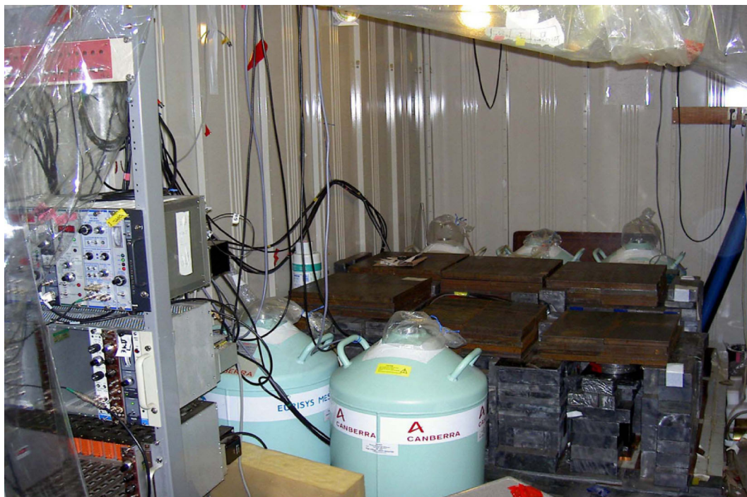
図3 尾小屋地下測定室内部。検出器のヘッドは分厚い鉛と鉄で遮蔽しており、検出器を冷却するための液体窒素の入ったデュワーしか見えない。奥に3台、手前に2台の検出器がセットされている
