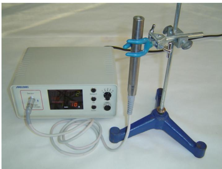
図 1 ポジトロンプローベおよび測定装置
