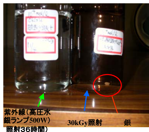
Fig. 5 紫外線照射とγ線照射後の写真(硫酸銀と亜硫酸ナトリウム混合溶液)
