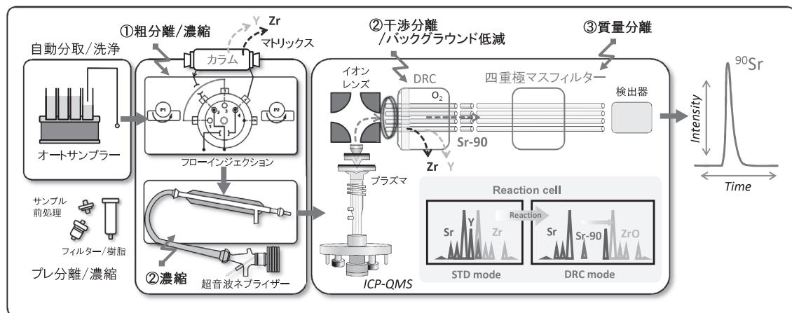
図3 ICP-MS法の概要図<sup>13)</sup>
