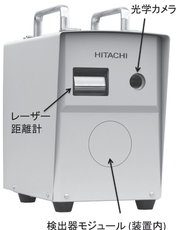
図2 CdTe半導体を用いたピンホール型ガンマカメラの写真。(提供：日立製作所 高橋勲氏)
