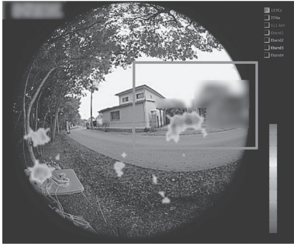
図4 ASTROCAMによる東電福島第一原発から20km圏内での実地試験。除染前（左：2013年6月取得）と除染後（右：2014年1月取得）の比較。除染作業によって、ホットスポットが除去されていることが画像上で明らかに分かる。ASTROCAMが、ホットスポットの検出だけでなく、除染作業の評価にも有用であることを示している
