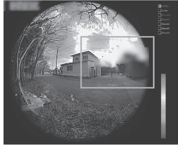
図4 ASTROCAMによる東電福島第一原発から20km圏内での実地試験。除染前（左：2013年6月取得）と除染後（右：2014年1月取得）の比較。除染作業によって、ホットスポットが除去されていることが画像上で明らかに分かる。ASTROCAMが、ホットスポットの検出だけでなく、除染作業の評価にも有用であることを示している
