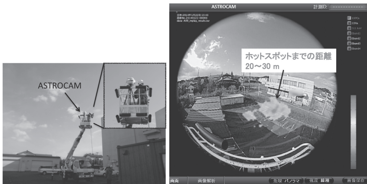
図5 ASTROCAMによる東電福島第一原発から20km圏内での実地試験。放射性物質が広く分布している状況で、遠方（20m以上）に存在するホットスポットも可視化し、敷地内の全体的な汚染状況を把握するために、高所作業車にASTROCAM 7000HSを搭載し、6mの高度から撮像した
