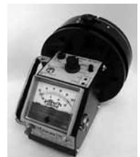
7-1 電離箱式サーベイメータ (1cm線量当量型) AE-133C/Λ1 55.65万円 校正は別途 1ヵ月
