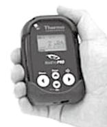
7-1 電離箱式サーベイメータ Mini-ION 約77万円 約5ヵ月
