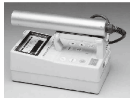
図1 NaI(Tl)シンチレーションサーベイメータ (TCS-172B) の特性及び写真
