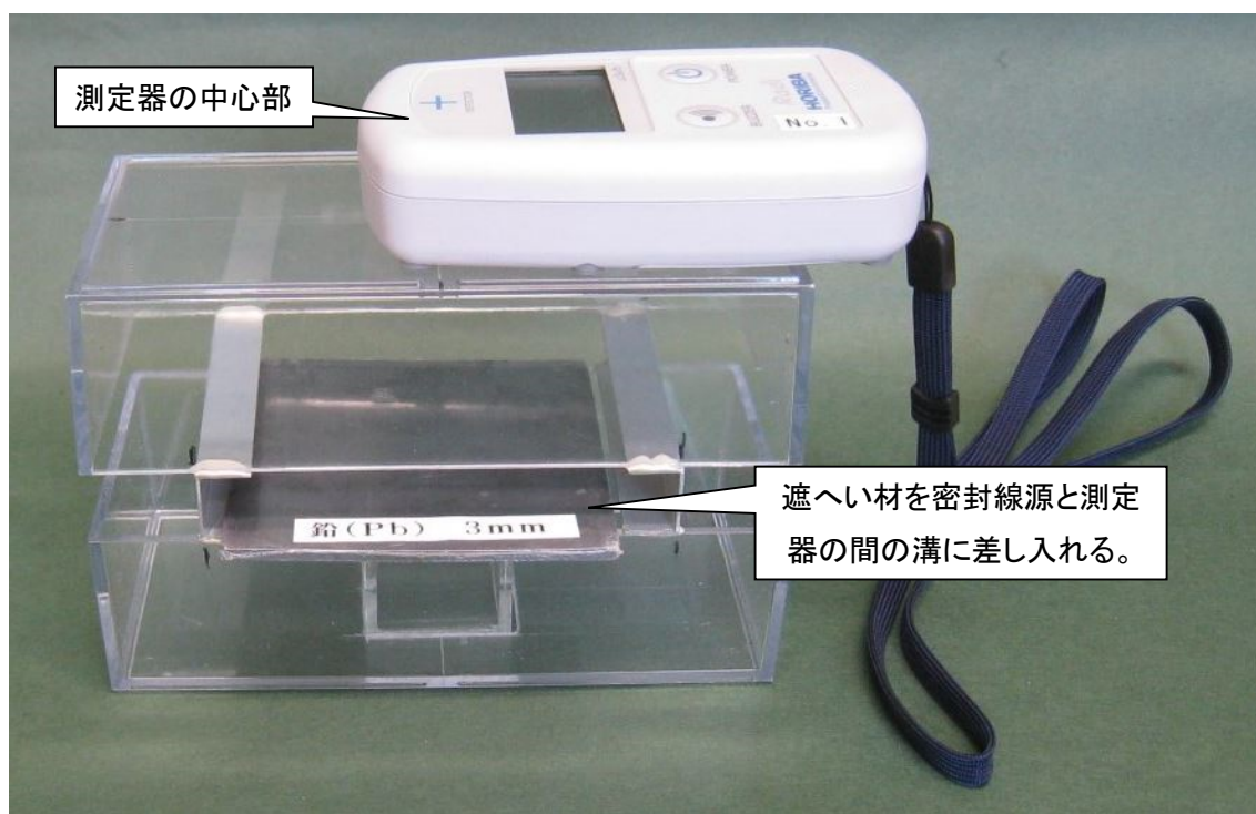
写真3 遮へい材の測定
