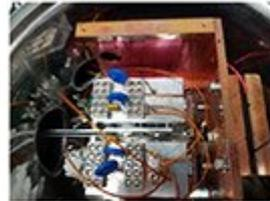
$^{229\text{m}}\text{Th}$ の $\gamma$ 線を測定する装置
