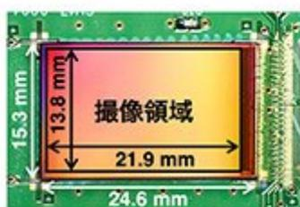
開発中の次世代宇宙X線観測用SOIピクセル検出器のチップ写真
