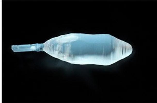
育成した放射線が入射すると光る「シンチレータ」とよばれる結晶の写真
