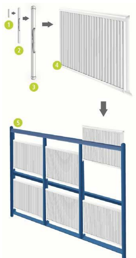
図 7. ^{60}\text{Co} 線源ラックの構成
