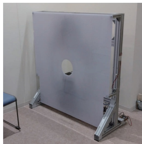
図3 開発した極超高解像度 CT 装置の外観
