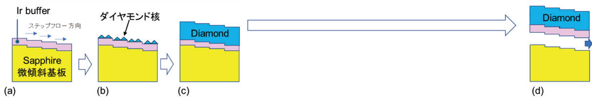
図1 マイクロニードル成長法（上段）とステップフロー成長法（下段）のプロセスフロー
