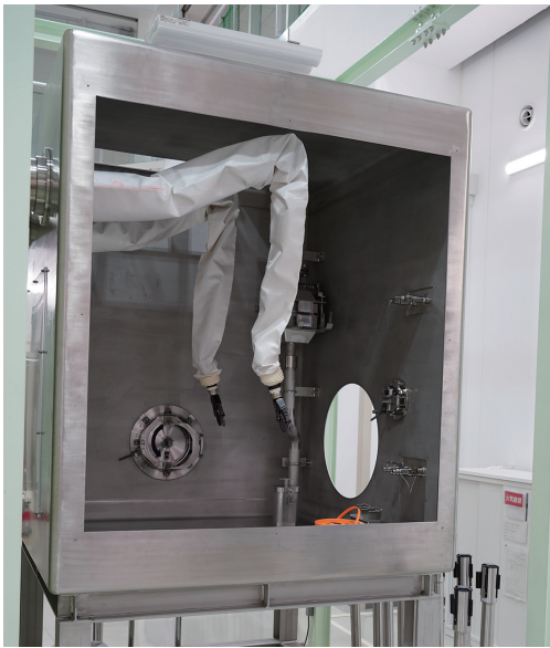
写真7 内部が見えるようになっているマニプレーターの設置されたシミュレーション用のセル
