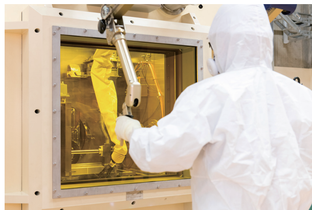
写真6 中レベル線量試料の前処理に使用する鉄セル（施設提供）
