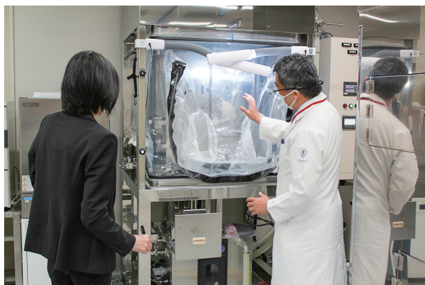
写真6 ホットラボ内の滅菌ガス安全キャビネット
