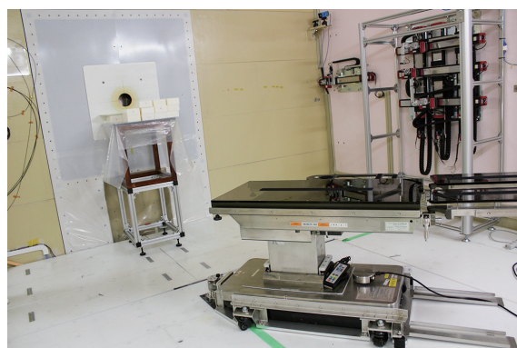
写真6 患者照射台(右手前)と中性子照射口(左奥)
