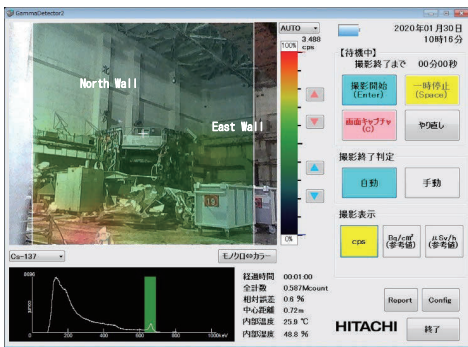
図6 北向き測定のガンマカメラ画面
