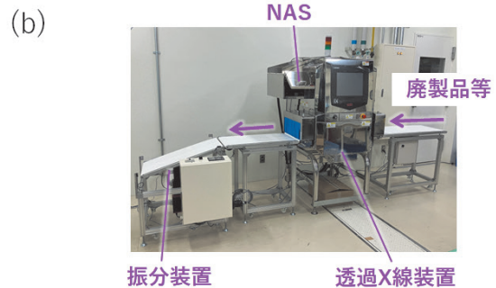
図4 電池自動検出・選別システムの(a)処理フロー、及び(b)外観(写真にPCは含まれない)(文献2,3)から改変)
