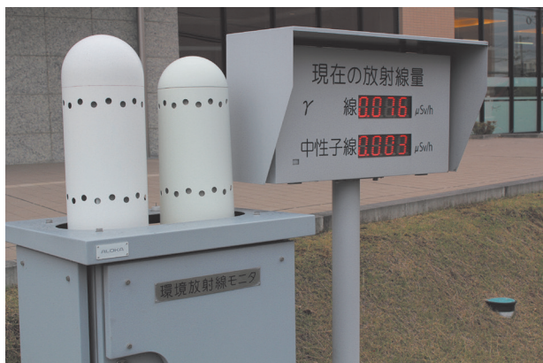
写真2 線量表示付モニタリングポスト
