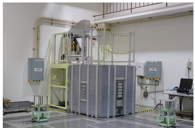
写真4 熱中性子場（黒鉛パイル）
