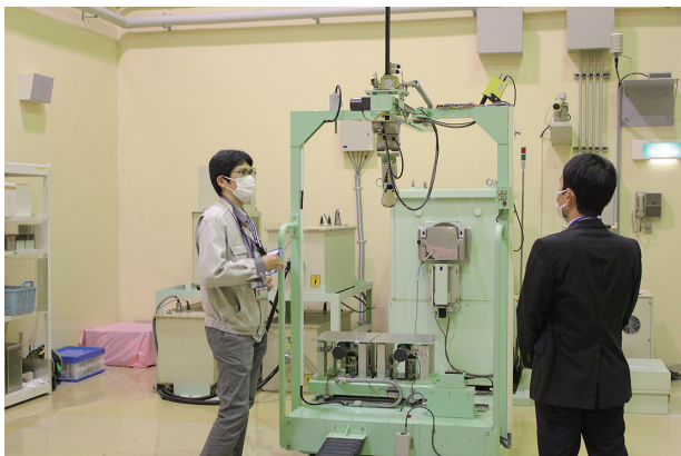
写真5 X線照射設備
