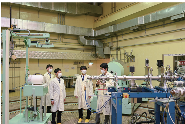
写真8 単色中性子線照射設備
