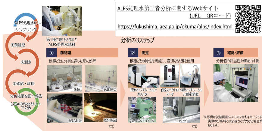
図3 ALPS処理水第三者分析の流れ
