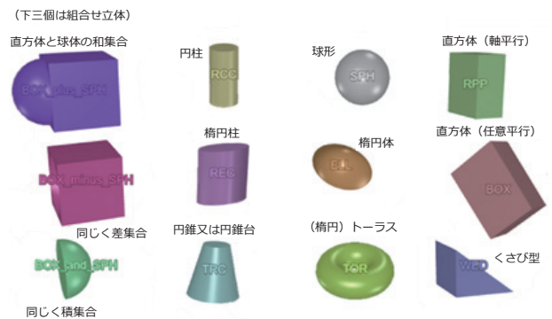
図4 遮蔽体として指定できる形状(基本立体と組合せ立体の例)
