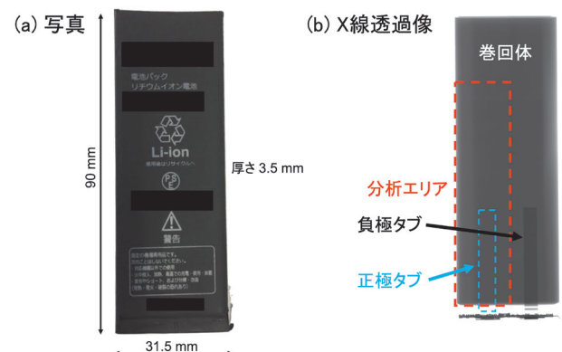
図3 分析に用いた LIB セルの写真と X 線透過像
