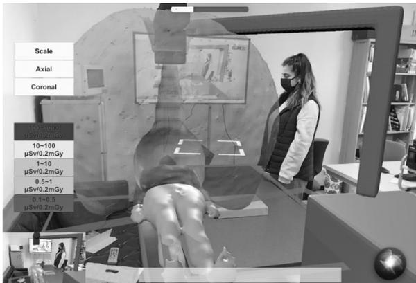
図6 iPad/iPhone用X線室散乱線可視化ARアプリケーション X-SERVEによる散乱線の可視化の様子。
