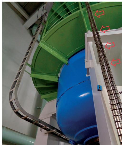
写真4 ペレットチェーンが展示されている (写真右側の矢印)
