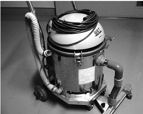
写真1 排水作業で使用した機材 (ナショナル社製業務用電気掃除機 MC-G660WS)
