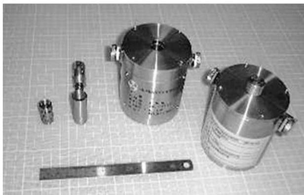
図1  $^{166\text{m}}\text{Ho}$  の2重密封線源(左端)と線源ケース(左2番目)、遮蔽付きキャリングフォルダー(右円筒)
