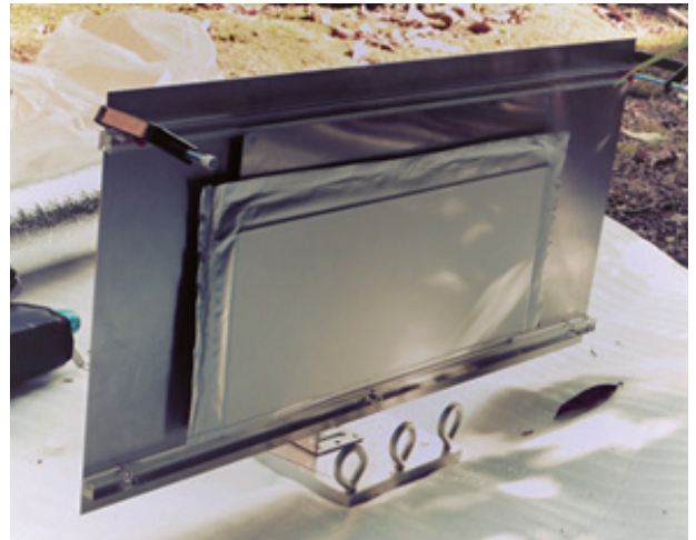
図6 春日古墳に設置した検出器とその設置台
