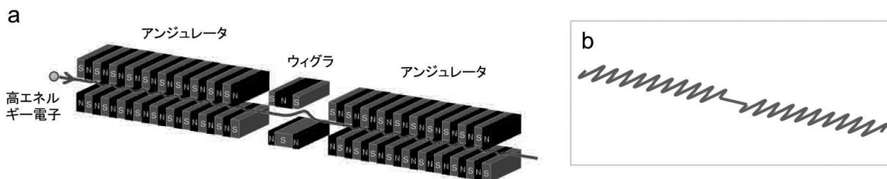
図 1(a) 10 周期磁場のアンジュレータを 2 つ直列に並べたタンデム型アンジュレータの概念図
