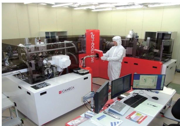
図5 大型二次イオン質量分析装置 (LG-SIMS)
