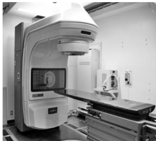
図2 直線加速装置（6 MeV）
