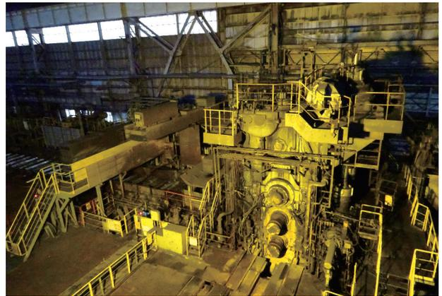
写真5 熱延工場の $\gamma$ 線厚さ計（中央下部に放射能標識が見える。写真中央の圧延機の左側に厚さ計2台が配置されている）
