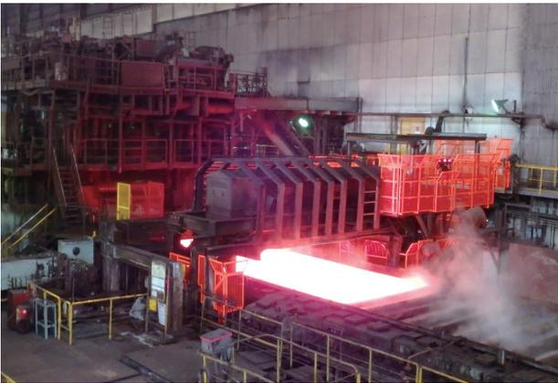
写真4 厚板工場で使用中の $\gamma$ 線厚さ計（見学当日は工場休止中であったので別日に撮影）
