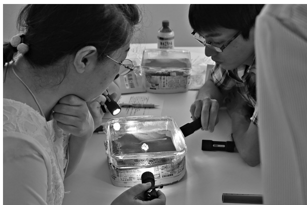
写真2 測定実習①簡易霧箱による放射線の飛跡の観察
