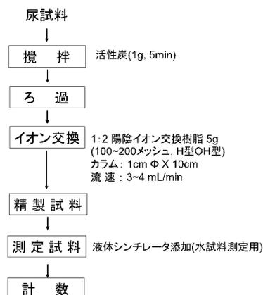
図3 尿中トリチウム測定の前処理試料調製法<sup>3)</sup>
