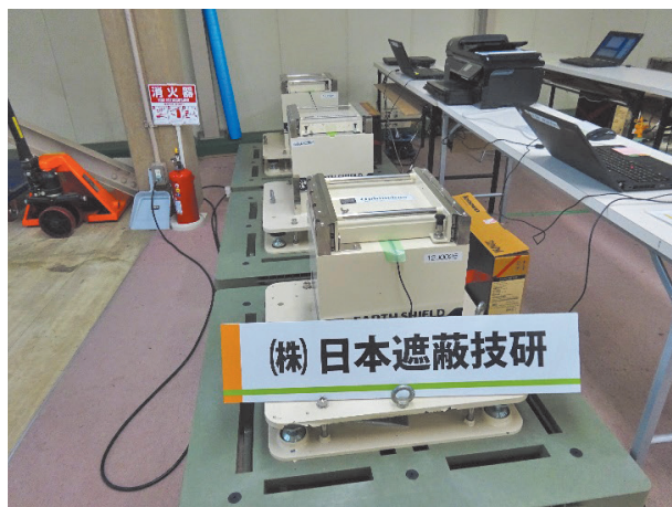
写真6 車積載型γ線スペクトロメトリ検査システムの測定器
