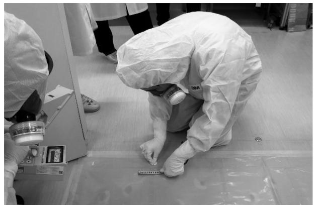
写真2 表面汚染のスミア試料採取の様子
