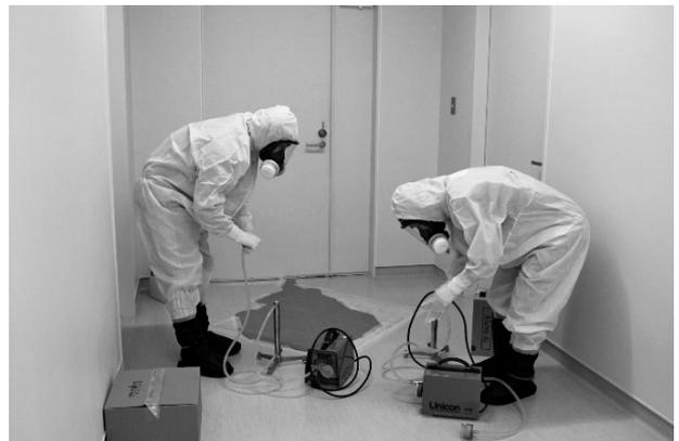
写真3 空気中の放射性ダスト採取の様子
