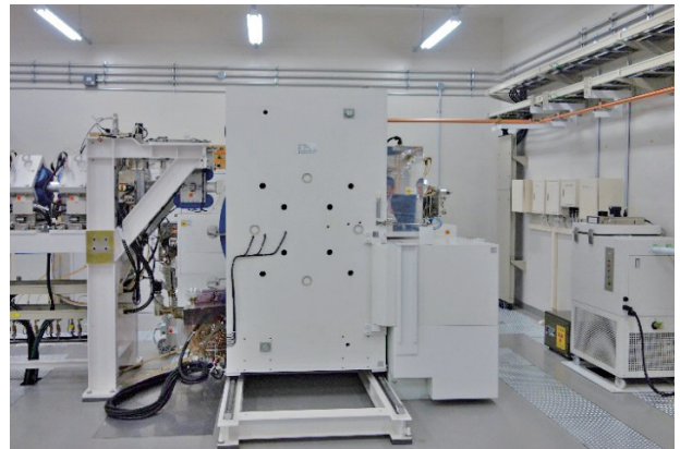
写真3 縦型サイクロトロン、右下部にPET核種用ターゲットが収められており、左上部から水平にビームを引き出す
