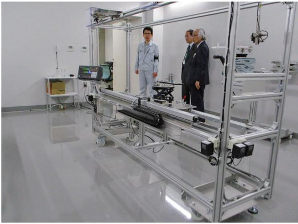
写真6  $\gamma$ 線の高線量用 JCSS 校正場，手前が位置合わせ装置
