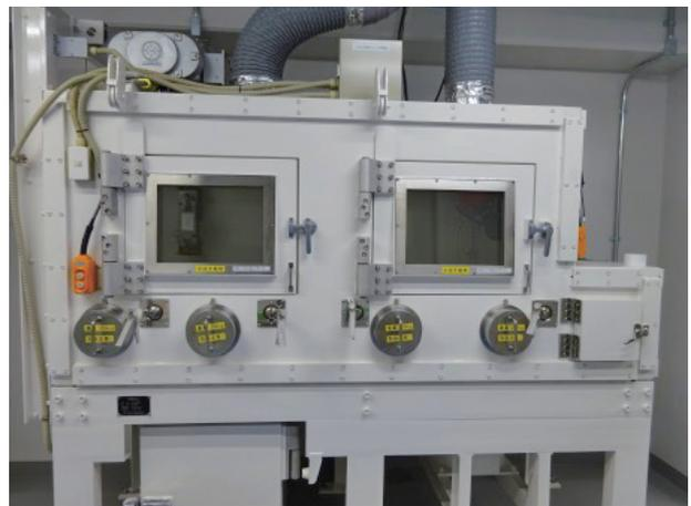
写真5 受入検査室の品質検査用鉛セル
