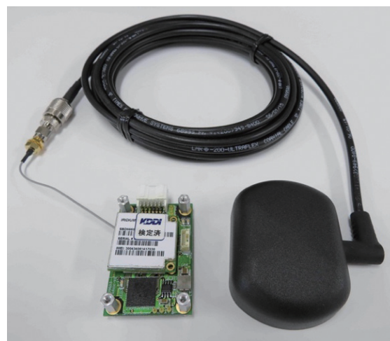
図4 イリジウムSBDを用いたパケット通信装置と専用アンテナ。白いものが30mm角程度のSBDデバイスで、コントロール基板に実装されている
