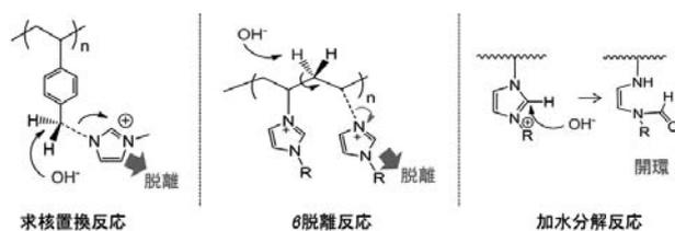
図5 イミダゾリウム型アニオン膜の分解機構
